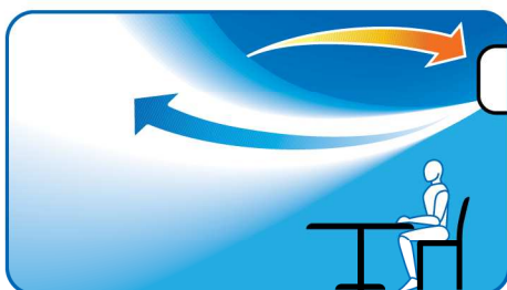
Správné nastavení směru lamely výdechu vzduchu zajistí požadovaný komfort
